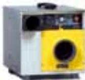
Es ist ein Luftentfeuchter, der ohne Kompressor und Kältemittel betrieben wird. Das Gerät arbeitet unabhängig von der Umgebungstemperatur und entfernt stets die gleichen Mengen von Wasser. Im Einsatz bei niedrigeren Temperaturen, d.h. unter 10°C, ist das Gerät wesentlich leistungsfähiger als Kondensationstrockner.
