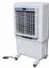
Die Luftkühler von Master kühlen die Luft ab, indem sie einfach und natürlich das Verdampfen von Wasser nutzen. Das von dem Behälter entnommene Wasser befeuchtet den großen Zellulosefilter, durch den mithilfe eines Hochleistungsventilators gleichzeitig Luft geblasen wird. Das an dem Filter verdampfende Wasser kühlt die Lufttemperatur um ein paar Celsius-Grad ab, wodurch dem Raum kühle und frische Luft zugeführt wird.
