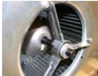
**Leistungsstarker Radialventilator, rauscharm 72 dB(A)**
